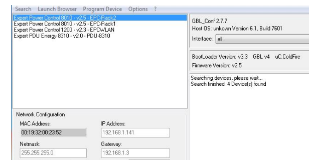
Abb. 2: Anzeige der gefundenen Geräte im Konfigurationsprogramm GBL_Conf
