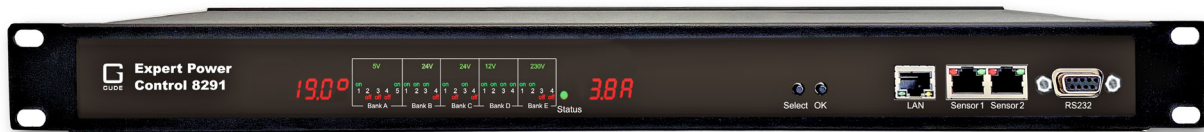
Front des Expert Power Control 8291-1: Statusüberblick über den angeschlossenen Geräte-Zoo
