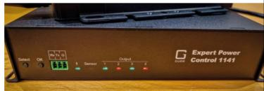
Auf der Oberseite des smarten Stromverteilers Gude Expert Power Control 1121 sowie der Vorderseite des 1141 lassen sich über zweifarbige LEDs schnell Informationen zum Betriebs- und Schaltstatus herausfinden. Bei den Outputs bedeutet rot, dass diese aus-, und grün, dass diese eingeschaltet sind. Über die Select-Taste lassen sich die Ausgänge auch manuell schalten.
