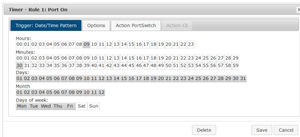
Man sieht hier die erweiterte Darstellung der ersten Regel des einfachen Timers aus dem vorherigen Beispiel. Die Aktion wird jeden Tag jedes Monats um 9:30 gestartet. Die Wochentage Samstag und Sonntag sind ausgeschlossen. Eine bestehende Regel kann mit dem "Delete" Schalter entfernt werden.
