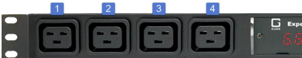
1. - 4. Lastausgänge für Phasen L1 bis L4 (IEC C19, max. 16 A)
