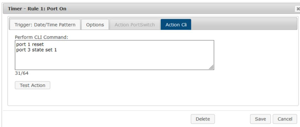
Anstatt einen Port zu schalten, kann man einen oder mehrere Konsolen Kommandos ausführen lassen. Diese Befehle werden im "Action CLI" Register eingetragen. Der "Action Cli" Register ist nur dann anwählbar, wenn bei "Options" die Option "Perform CLI Cmd" aktiviert ist.
