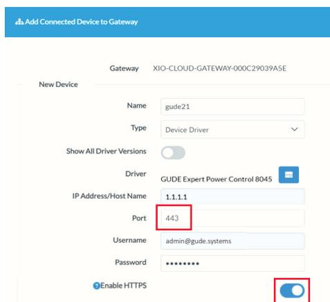
Allerdings ist eine HTTPS-Verschlüsselung ratsam. Sie ist mit dem entsprechenden Schieberegler sowie der Eingabe *Port 443* schnell eingerichtet. Schließen Sie die Einrichtung mit dem Button *Add Device* ab.
