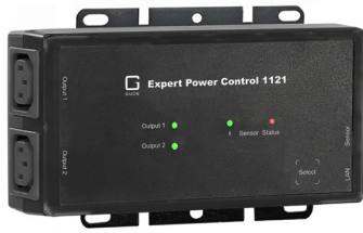
2 Lastausgänge IEC C13 auf der linken Seite
