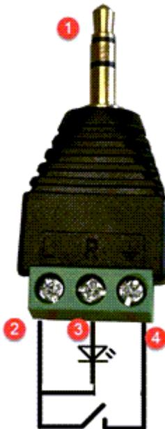
Der Klinkenstecker (1) wird in die Frontplatte des EPS 8112 gesteckt. Zwischen (2) und (4) wird ein potenzialfreier Schalter angeschlossen. Zusätzlich kann eine LED (3) im Schalter angesteuert werden. Diese LED ist intern mit einem 560R Widerstand an 5V aufgehangen.
