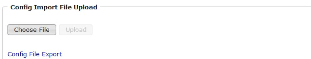
Durch die Funktion "Config File Export" kann die aktuelle Konfiguration als Textdatei gespeichert werden. Die verwendete Syntax in der Konfigurationsdatei entspricht den Befehlen der Telnet Konsole. Soll die Konfiguration eines Gerätes aus einer Textdatei wiederhergestellt werden, so muss erst die Datei mit "Upload" hochgeladen und dann das Gerät mittels "Restart Device" neu gestartet werden.
