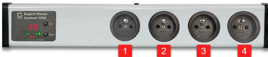
4 x Lastausgänge (CEE 7/3 Typ E, max. 16 A) bei Expert Power Control 1202-2 / 1292-2
