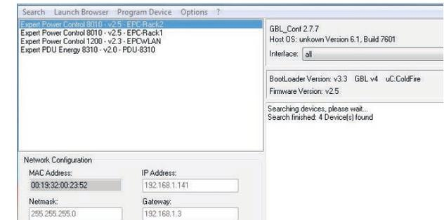
Abb. 2: Anzeige der gefundenen Geräte im Konfigurationsprogramm **GBL\_Conf**
